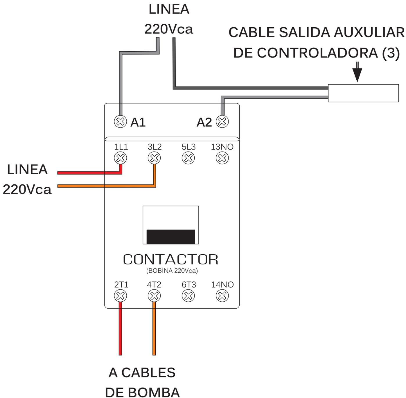
NOTA: LA POSICION Y DENOMINACION DE LOS BORNES DE CONEXION DE LA BOBINA DEL CONTACTOR (A1 Y A2) PODRIAN DIFERIR DEPENDIENDO DEL FABRICANTE Y MODELO.
